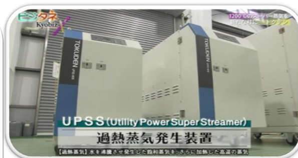
▲ 過熱蒸気発生装置 (UPSS) 最高 1200℃の蒸気を発生可能
